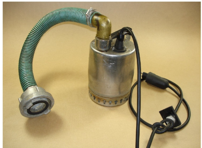
Das metallene Gehäuse der Wasserpumpe stand aufgrund fehlerhafter Schema III Installation unter Spannung
