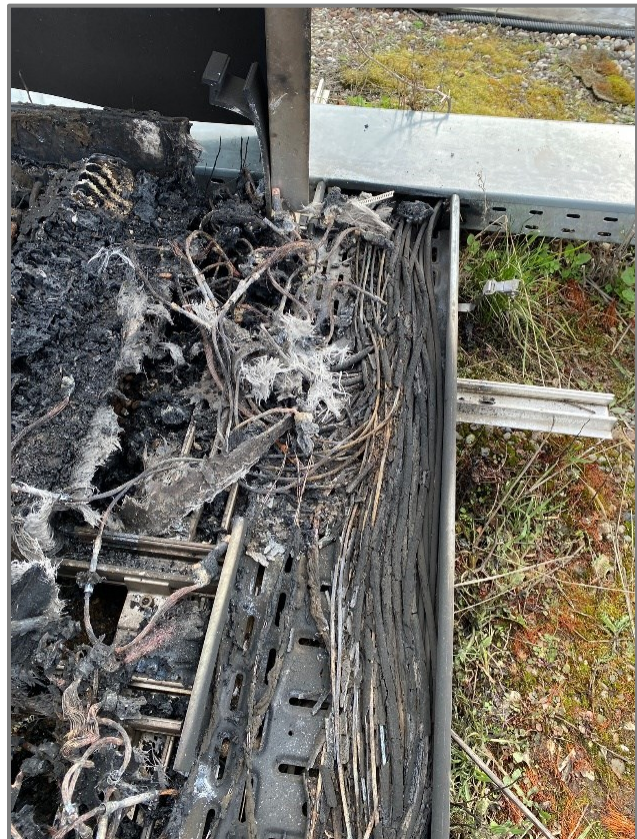
Scatola di derivazione del generatore fotovoltaico bruciata
