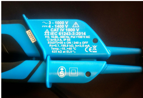
Abbildung 4 Das freiwillige Sicherheitszeichen besteht aus einem S und einem darüber liegenden +, oval umrandet.
