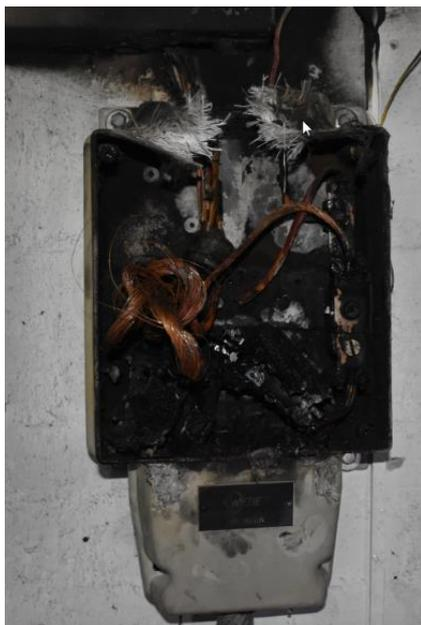
Il controllore elettricista ha aperto la cassetta di allacciamento dell'edificio, smontandone la copertura. Egli ha eseguito, sempre sotto tensione, il controllo delle viti. Al collegamento L1 le viti potevano ancora essere strette. Nel momento in cui voleva stringere L2, si è verificato un cortocircuito con un arco elettrico. Non è più possibile comprendere la causa di questo arco elettrico.
