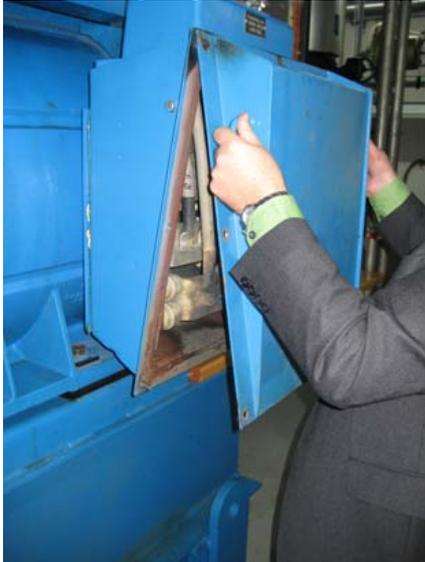
Nach dem Beschriften der Kabel wollte ein Mitarbeiter rasch möglichst den Motorendeckel wieder verschliessen. Er montierte den Deckel um 180 Grad verkehrt und erzeugte dabei einen Kurzschluss zwischen dem geerdeten Gehäuse und einem Polleiter. Das Motorengehäuse wurde unter voller Spannung geöffnet. Keine der anwesenden Personen trug eine Schutzausrüstung, obwohl der Personenschutz in keiner Weise gewährleistet war.
