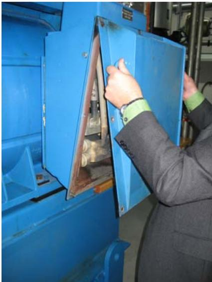
Après avoir étiqueté les câbles, un collaborateur a voulu remettre le couvercle du moteur en place le plus vite possible. Il a monté le couvercle à l'envers de 180 degrés et provoqué ainsi un court-circuit entre le carter mis à la terre et un conducteur polaire. Le carter du moteur a été ouvert sous pleine tension. Aucune des personnes présentes ne portait d'équipement de protection individuelle bien que la protection individuelle n'était en aucune façon assurée.
