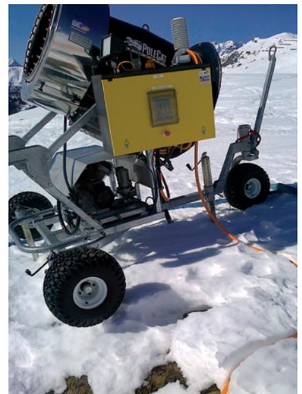
Figura 4 Conduttura di alimentazione del cannone da neve. **Non conforme alle norme!**
