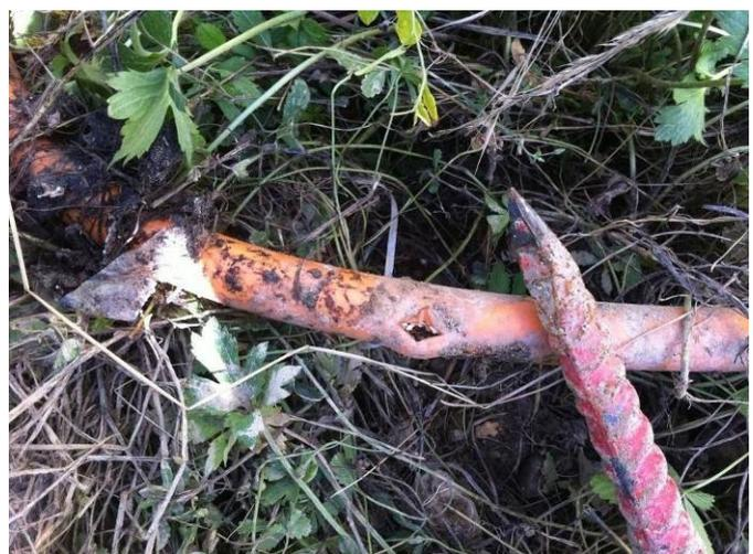
Câble PUR endommagé sans protection mécanique.
