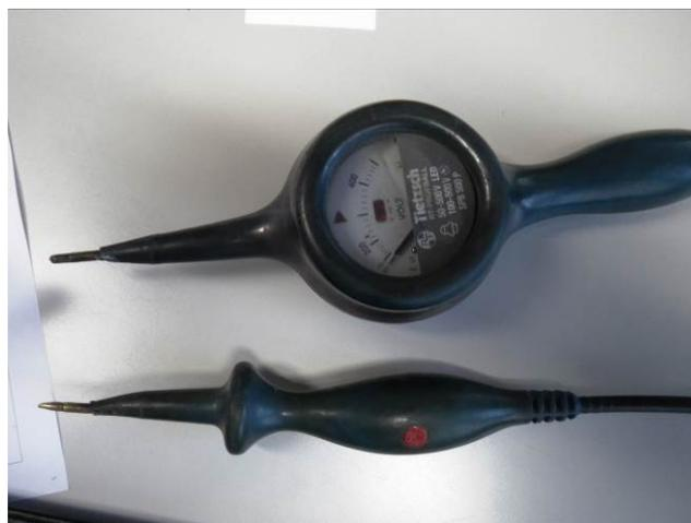
Vieil appareil de mesure, non sécurisé selon SN EN 61010-031
