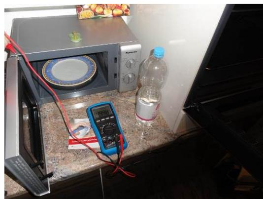
Différence de tension entre le conducteur de protection et le boîtier de 115 V.
