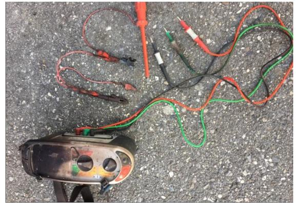
L'apparecchio di misurazione è stato attraversato dal corto circuito.
