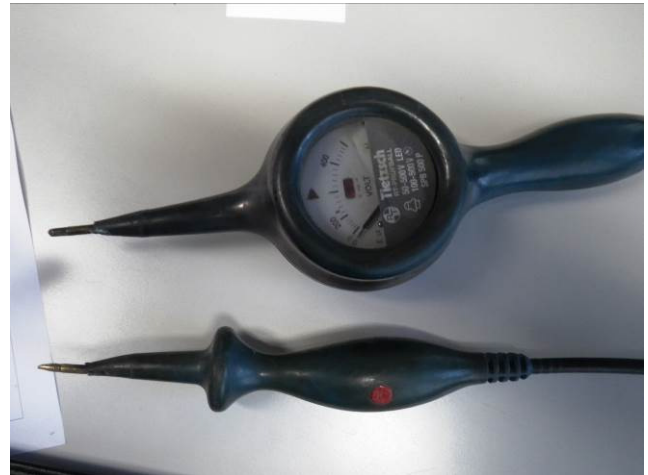
Altes Messgerät, Messspitzen nicht gesichert nach SN EN 61010-031
