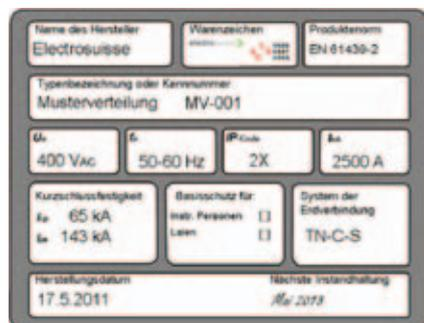
**Illustration 3** La résistance au court-circuit (Kurzschlussfestigkeit) est indiquée sur la plaque signalétique de l'ensemble d'appareillage.
