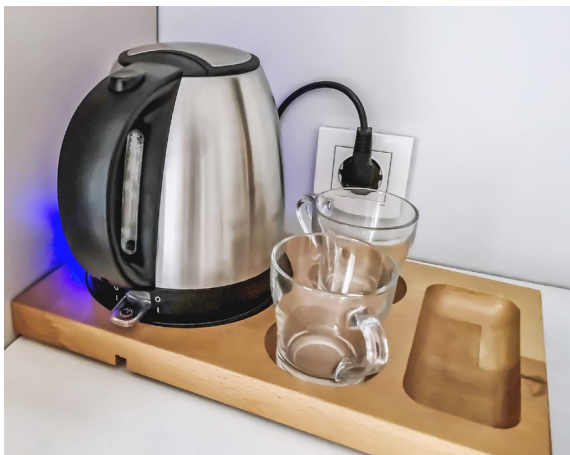
Abbildung 6 Elektrogeräte mit ausländischen Steckern (insbesondere deutsche Schutz-Kontakt-Stecker «Schuko») dürfen nicht an Konsumenten und die Industrie in der Schweiz abgegeben werden, da durch Manipulationen spannungsführende Teile berührt werden können.
