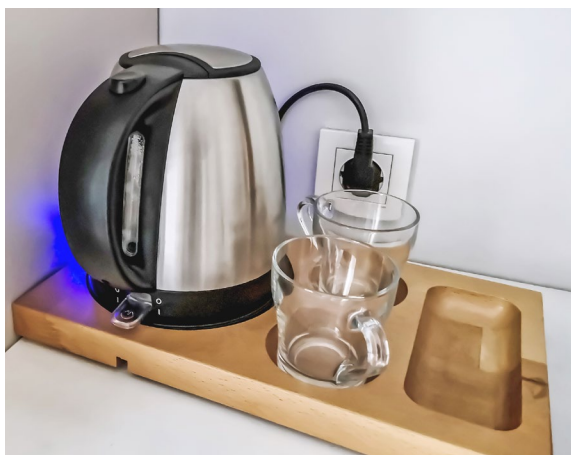
Figura 6 Gli apparecchi elettrici dotati di spine estere (in particolare prese Schuko) non possono essere forniti ai consumatori e all'industria in Svizzera poiché, in caso di manipolazioni, si rischia di entrare in contatto con parti sotto tensione.
